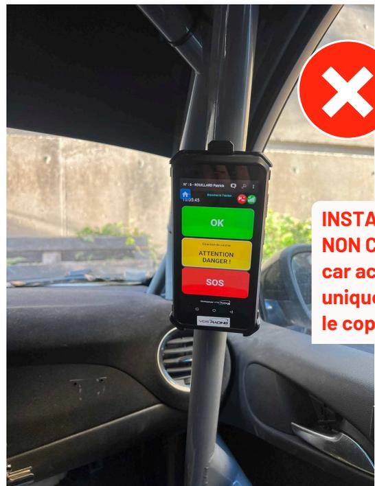
**INSTALLATION NON CONFORME car accessible uniquement par le copilote.**
